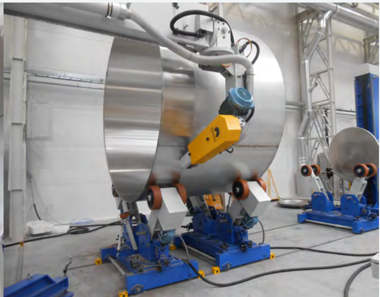
VERARBEITUNG DER BODENKANTEN
