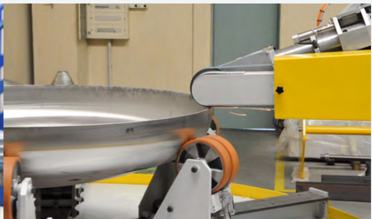
VERARBEITUNG DER BODENKANTEN
